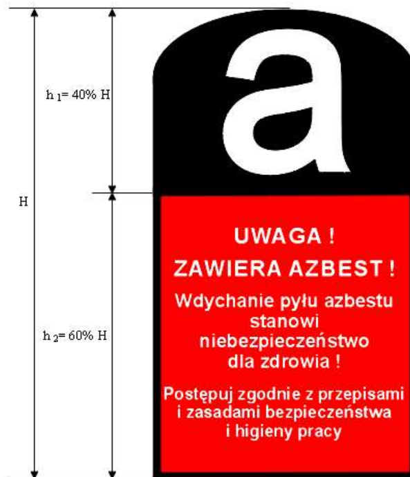
Rysunek 4. Wzór oznakowania instalacji lub urządzeń zawierających azbest oraz rur azbestowo-cementowych.
